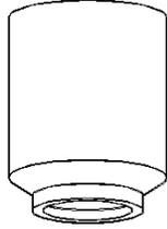
Étape 1. Localiser la cheminée dans un endroit pratique aussi proche que possible de la sortie de l'appareil. Découpez et encadrez un trou dans le toit pour le support. Les côtés de ce trou doivent être verticaux (voir Figure 10) (voir Tableau 2 à la page 3).
